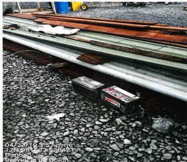
Fig. 2.7. En la inspección al taller del GMP, se evidencio batería sin medida de contención secundaria y en contacto directo con el suelo y a la intemperie.
