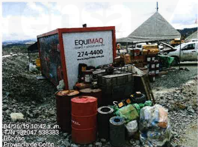
Fig. 2.8. En el área del taller de mecánica EQUIMAC, se observó almacenamiento inadecuado de recipiente con aceite sin medidas de contención secundaria y colocada a la intemperie.
